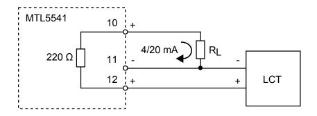
Example Barrier: MTL7706+ 200 Ω ≤ R<sub>L</sub> ≤ 800 Ω
